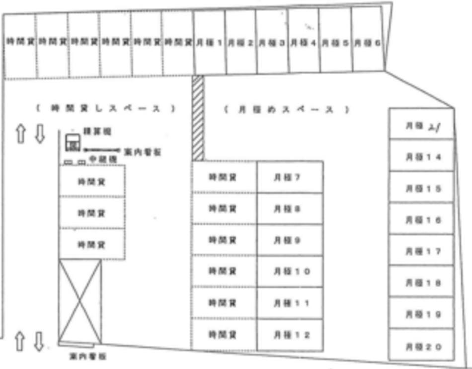
車室幅2.35m、長さ5.0m、前面通路幅5.0m
